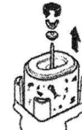
1. Ta bort klippet och demontera lufttrenarens hölje eller skruva av muttrarna och lufttrenarens kåpa.
