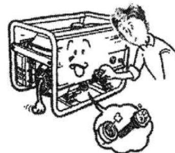
1. Vrid av oljefilterlocket och rengör oljestickan med en ren trasa.
